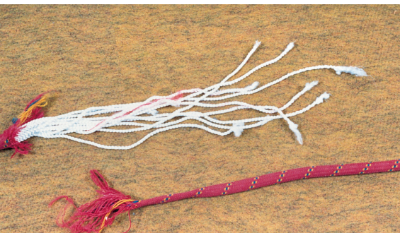
Lina wielokrotnego odpadnięcia zerwana na Laserzwand
