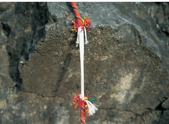
Lina wielokrotnego odpadnięcia zerwana na Laserzwand
