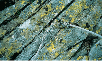
Zadziałała niszczyielska siła (u góry po lewej), typowe uszkodzenie wskutek zmęczenia materiału (u dołu po lewej) oraz błąd konstrukcyjny; zbyt mała średnica prętu tworzącego kotwę, powodująca jego rozgięcie pod obciążeniem
