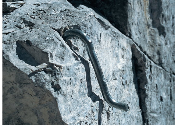
Zadziałała niszczyielska siła (u góry po lewej), typowe uszkodzenie wskutek zmęczenia materiału (u dołu po lewej) oraz błąd konstrukcyjny; zbyt mała średnica prętu tworzącego kotwę, powodująca jego rozgięcie pod obciążeniem
