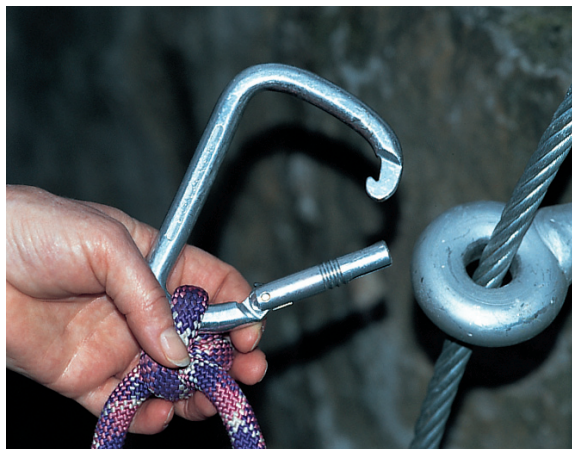
Na ferracie Seewand-Klettersteig (po lewej): karabinek uderzył o kotwę ze zbyt dużą siłą, rozgiął się i wypiął ze stalowej liny
